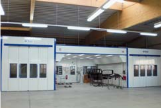
Das Herzstück der Lackieranlage bilden zwei Kombikabinen mit dazwischenliegendem Abdeckbereich.
